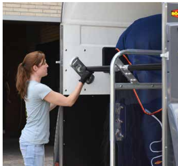
Abladen: Die hintere Boxenstange wird erst ausgehängt, wenn die vordere Boxenstange ausgehängt und das Pferd losgebunden ist.
