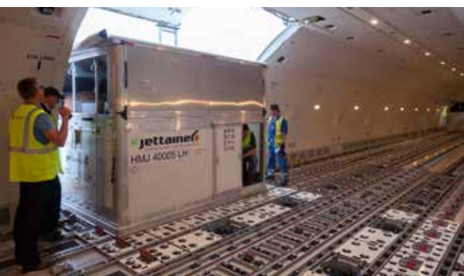
Die Wände der Transportboxen bestehen aus Polymer, das temperaturbeständig ist und vor allem hell. So haben die Pferde nicht das Gefühl, in die Dunkelheit gehen zu müssen.
