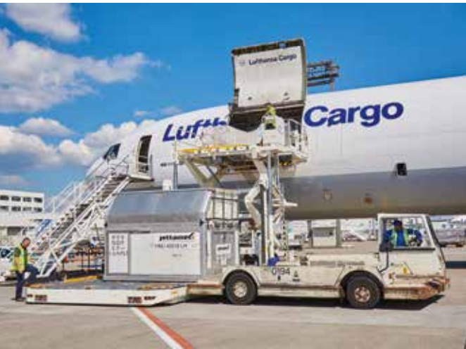
Die Transportboxen werden mit Hub-Fahrzeugen und auf Förderbändern in den Bauch der Maschine gebracht.
