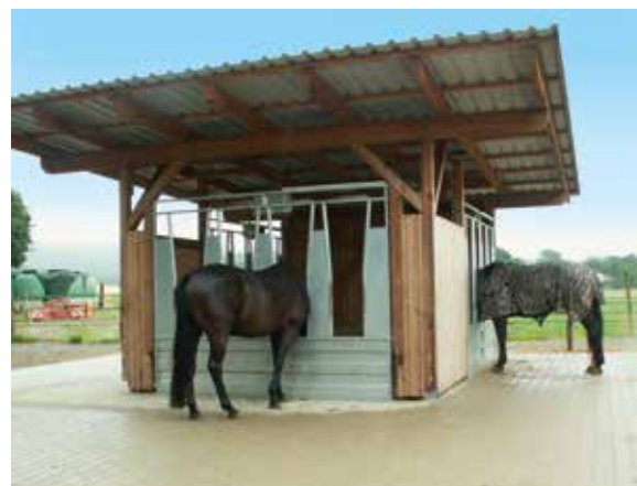
Die Heuraufe öffnet sich zeitgesteuert über ein elektri- sches Fressgitter
